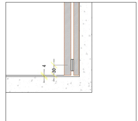
Dettaglio sezione verticale pannellatura e sottostruttura con altezza da terra mm 4.
