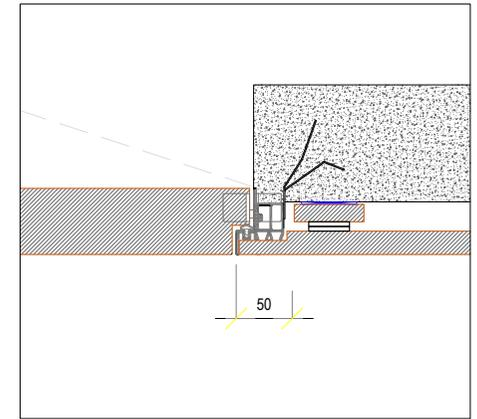
Particolare nodo fissaggio telaio battente (lato cerniera) per muro ad intonaco.
