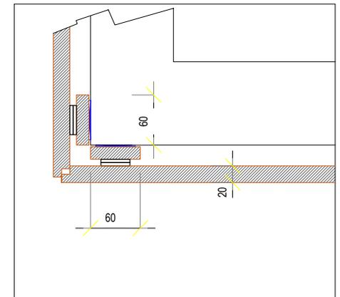
Particolare nodo angolo esterno con fissaggio composizione sottostruttura e lavorazione pannelli.
