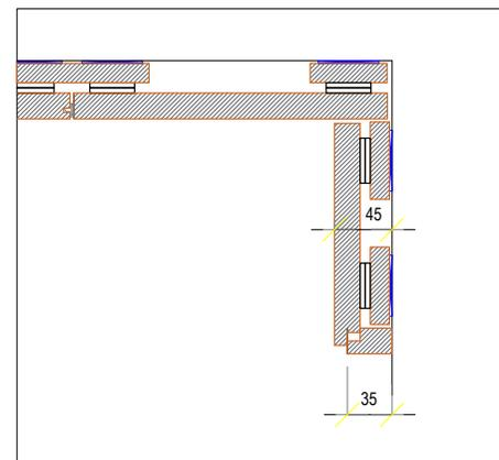
Particolare nodo angolo interno con fissaggio composizione sottostruttura e lavorazione pannelli e tappo speciale di chiusura.
