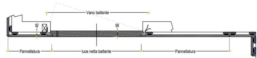
Schema di posizionamento delle fasce verticali sottostruttura per il fissaggio pannelli alla parete e dei montanti telaio porta a Battente.
