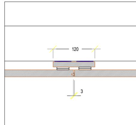
Particolare nodo fissaggio pannellatura continua con fuga mm 3 variabile (con guarnizione).
