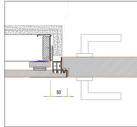
Particolare nodo fissaggio telaio battente lato serratura (per muro di cartongesso)
